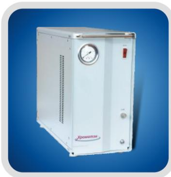
Компрессор предназначен для получения сжатого воздуха, не загрязненного продуктами трения и смазки, для питания пламенных детекторов или в качестве газа-носителя. Отличительные потребительские качества компрессора - низкий уровень шума и стабильное выходное давление, достигнутое специально для работы с лабораторными газовыми хроматографами. Для дополнительной очистки комплектуется двумя адсорбционными фильтрами.
