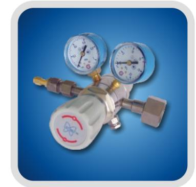
Двухступенчатый баллонный регулятор давления (редуктор) - первый в России двухступенчатый регулятор давления, разработанный специально для газовой хроматографии. Предназначен для работы с газами: азот, гелий, аргон, воздух. Обеспечивает точное поддержание давления на выходе баллона. Исключает скачки давления, натекание и повышенный фон, наблюдаемые при работе с обычными редукторами. Сертификат соответствия N РОСС RU. МГО5. В00009 от 22.04.2008
