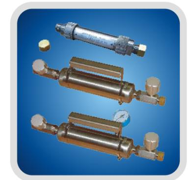
Предназначены для отбора проб сжиженных углеводородных газов, нестабильного газового конденсата, нефти и нефтепродуктов из баллонов, трубопроводов, железнодорожных цистерн и стационарных емкостей. Пробоотборники изготовлены в соответствии с требованиями ГОСТ 14921. Выпускается несколько исполнений пробоотборников типа ПУ и ПГО в зависимости от объема, типа вентиля, материала корпуса, наличия манометра (для газовых проб).
